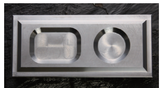
ランピング加工 Ramp cutting
